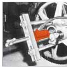
Hydraulisch betätigter Push-Puller®-Abzieher mit Abziehplatte beim Abziehen eines Antriebsrades.
