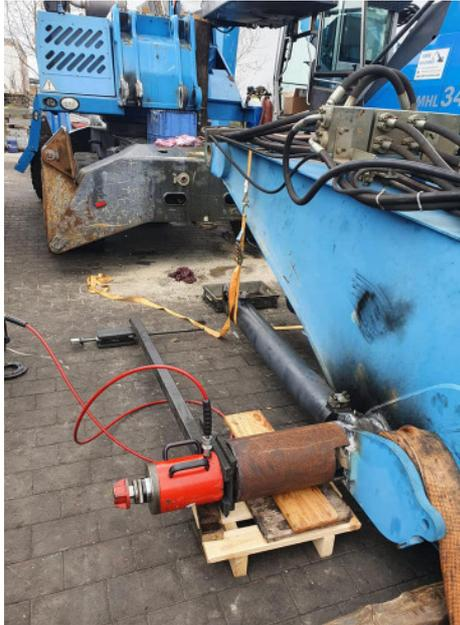
hydraulische 60t Hohlkolbenpresse vom SIT Powerteam beim Bolzenziehen am Greifarm einer Umschlagsmaschine von TerexFuchs MHL340
