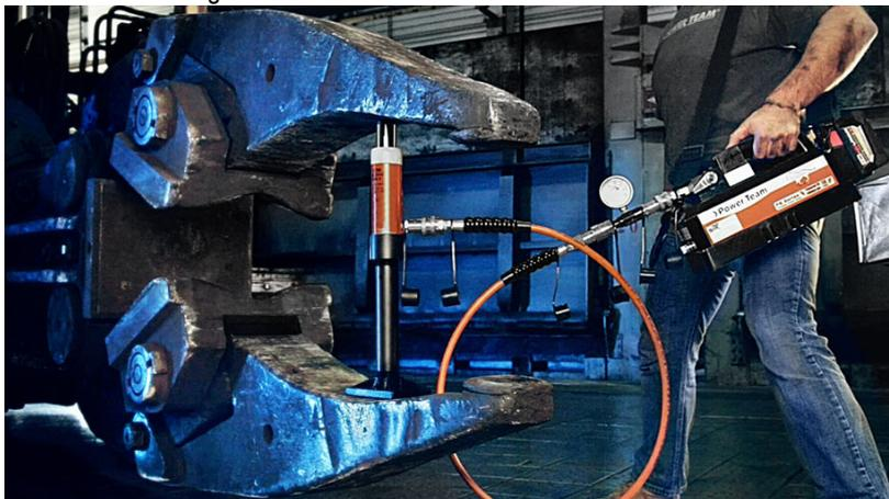
hydraulischer 10t Allzweckzylinder mit Stützsockel und der 700bar Akku-Hydraulikpumpe BP102-2 von PowerTeam
