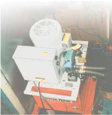
Eine PE4004S-Pumpe und ein RD3006-Zylinder beim Einsatz in einer Spezialpresse zur Reparatur defekter Kettenglieder in der Schiffsbauindustrie.
