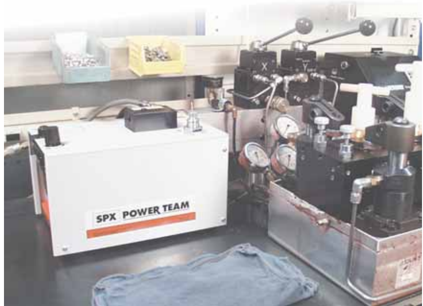
Die PAG0-Pumpe beim Einsatz in einer Spannvorrichtung.
