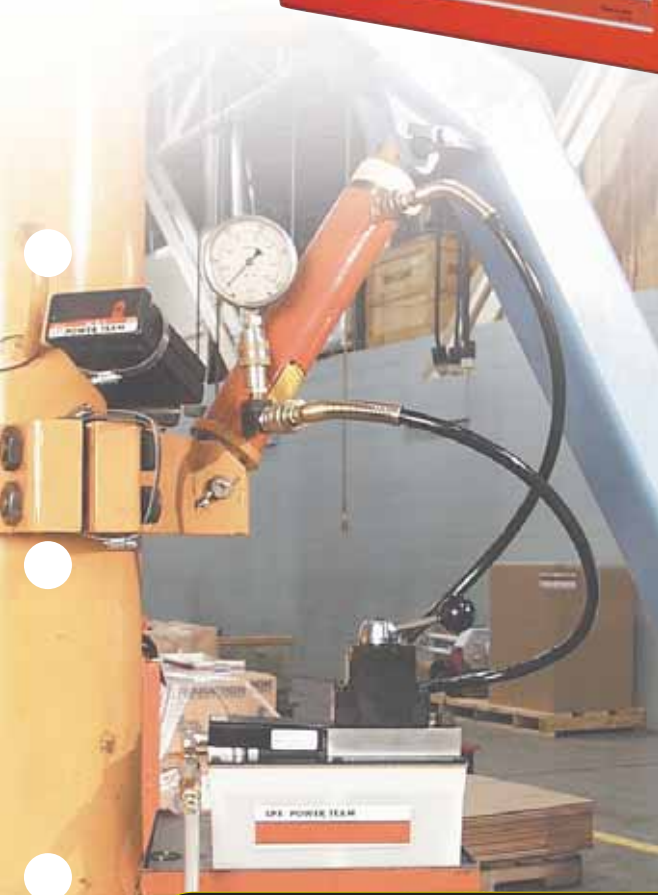
Die PA6D-Pumpe in einer Prüfvorrichtung mit einem digitalen Manometer DG100 und einem 25-Tonnen-Zylinder.
