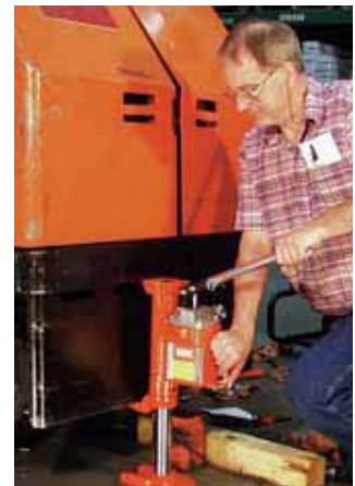
Ein Zungenheber der besonders robusten Reihe J bei Servicearbeiten an einem Hubwagen.
