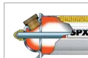
Die Handpumpen von Power Team sind mit einem angewinkelten Füllstutzen und einem eingebauten Überdruckventil-Sicherheitsystem ausgerüstet. Dieses System verhindert, dass ein plötzlicher Rückstrom, Überdruck im Tank verursacht. Zudem wirkt es als Dichtung und verhindert so das Austreten von Öl.
