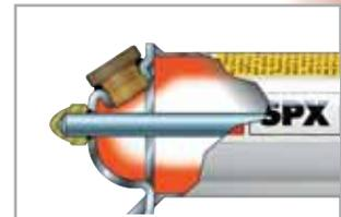
Die Handpumpen von Power Team sind mit einem angewinkelten Füllstutzen und einem eingebauten Überdruckventil-Sicherheitssystem ausgerüstet. Dieses System verhindert, dass ein plötzlicher Rückstrom, Überdruck im Tank verursacht. Zudem wirkt es als Dichtung und verhindert so das Austreten von Öl.
